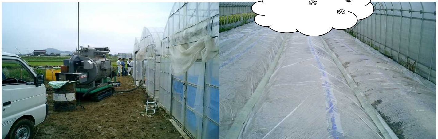
蒸気土壌消毒機の試運転の様子 (まるで蒸気機関車のように)
