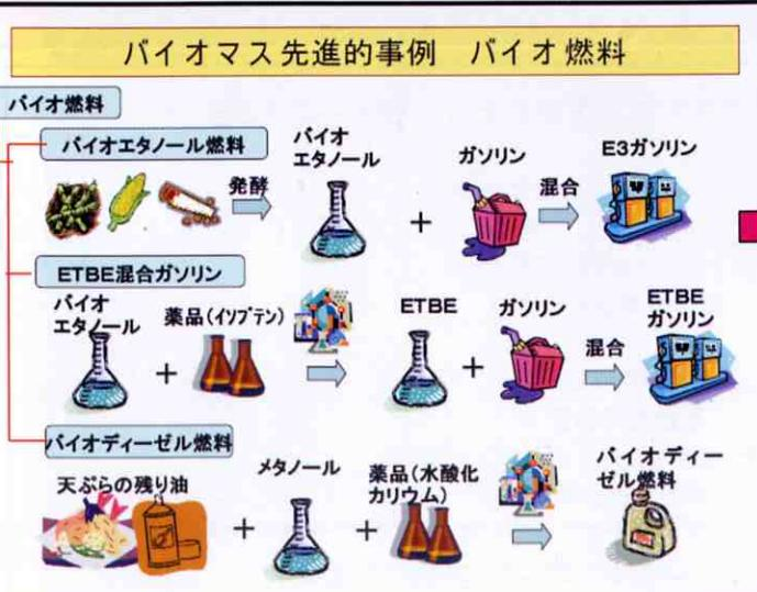
バイオ燃料には、サトウキビから作ったエタノールをガソリンに混ぜる、更にETBE添加剤にして混ぜる、廢油からディーゼル油を精製するなどがあり、最近国も力を入れています。
