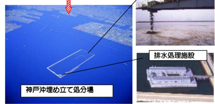
運ばれた焼却灰は、フローティングコンベアで、処分場内に偏らずに放出されます。排水時には、排水処理施設で水を浄化してから海に流します。H13年から開始された神戸沖処分場の埋め立てでは、現在約821万m<sup>3</sup>が埋め立てられました。新しい大阪湾フェニックス計画では、平成33年度までの廃棄物の受入を計画しています。大阪湾圏域の自治体では、**陸域での最終処分場の確保が一層困難**となり、一般廃棄物の大阪湾フェニックス計画への依存率が年々増大し、今後80%を超えることが予想されます。
