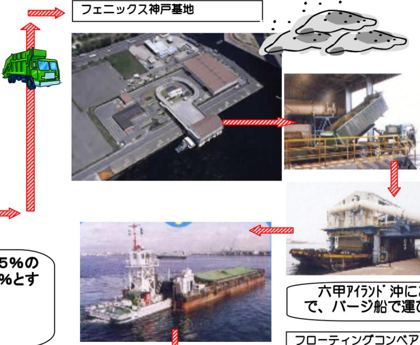
焼却灰は、再度、トラックでフェニックスの基地である神戸基地(灘区灘浜町)に運ばれます。神戸基地では、搬入物の検査のほか、焼却灰などの保管等を行い、検査を終えた焼却灰は、投入ステージからダンピングによってバースhipに積み込まれます。
