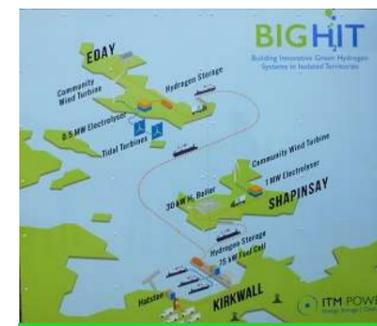
BIG HIT実証実験のパネル図。上部のイーデイ島で生成された水素をフェリーによってメインランドのカークウォールまで運搬します。
