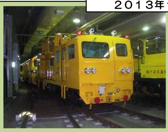
架線のチェックとメンテナンスを行う作業用車両。
