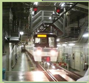
通電をして点検中の車両
